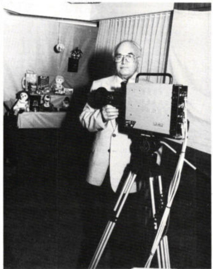
Het proefmodel van de CCD-camera is ondergebracht in het standaard-frame van een RCA camera van het Hawkeye-type. Op de foto poseert ingenieur Sid Bendell, hoofd van het camera-ontwerpteam van RCA's Commercial Communications Systems Division, gevestigd in Camden, New Jersey. De achtergrond toont het decor met de attributen die in Montreux de „live”-prestaties van de CCD-camera onthullen.
