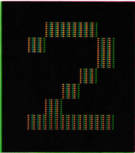
Afb. 1. Voorbeeld van een weergegeven patroon door een matrix van 56 \times 56 punten. De rode, groene en blauwe elementen zijn tegelijkertijd bekrachtigd.
