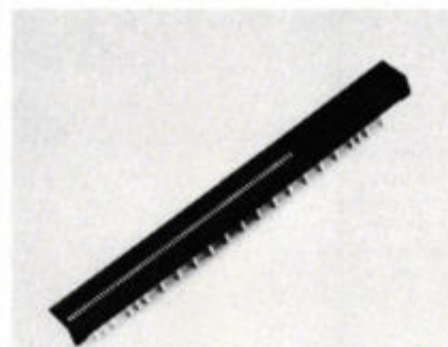
De HDSP-8820 heeft een totale lengte van 105,8 mm en beschikt over 101 rood oplichtende LED-elementjes. Dergelijke LED-balken vormen een interessant alternatief voor allerlei mechanische positie-indicatoren (foto HP).
